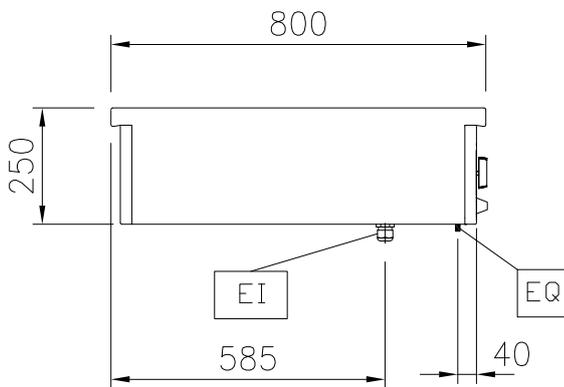
EI = Conexión eléctrica (energía)
